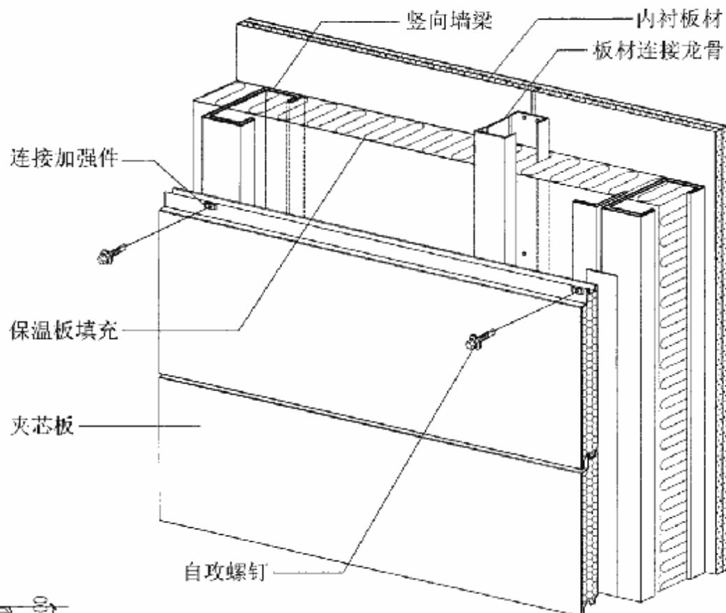
**墙9-承插型夹芯板复合保温墙体(横向排板)构造**
