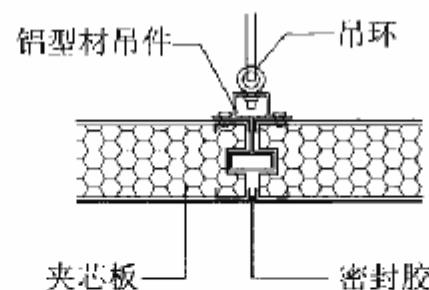
④ 吊顶长度宽度方向连接
