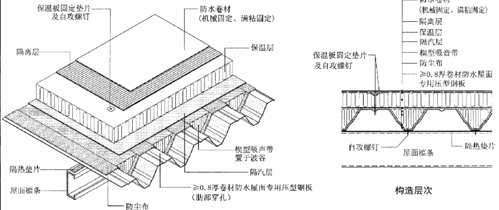
屋T2、屋T2A-压型钢板复合保温卷材防水吸声屋面构造
