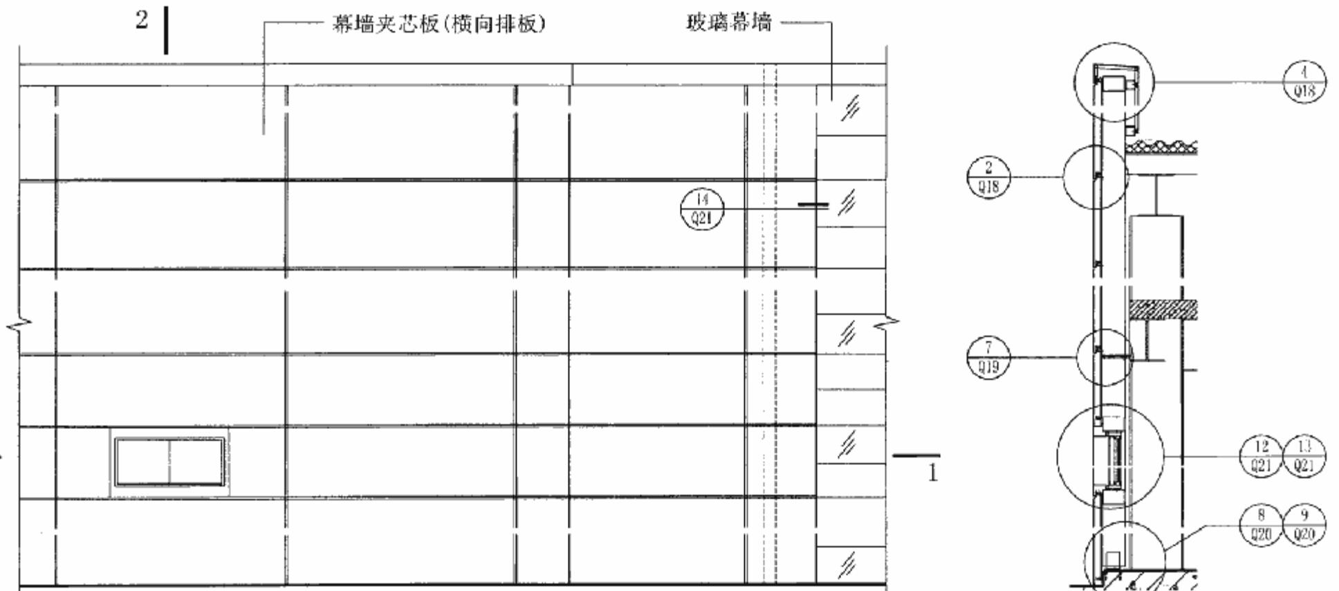
2 | 墙10-承插型夹芯板幕墙(横向排板)立面示意图
