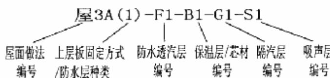
2. 根据墙体构造选择一种做法, 如墙3, 然后依次选择外侧板排板方式、防水透汽层、保温层或芯材、隔汽层、吸声层种类。例:
