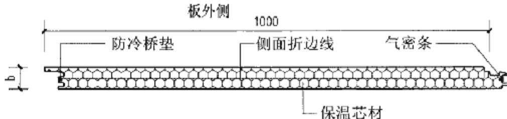
承插型幕墙夹芯板(横向排板)板型
