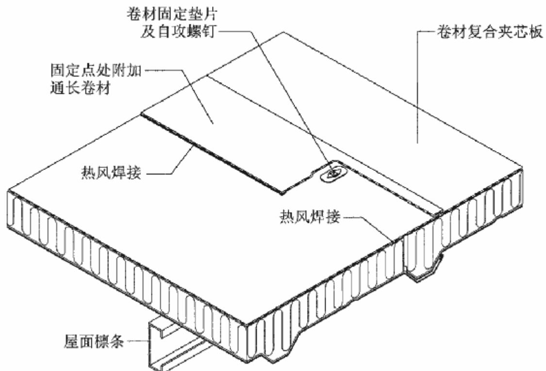
卷材复合夹芯板屋面构造
