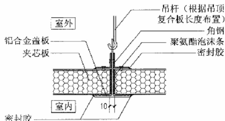
③ 吊顶长度方向连接
