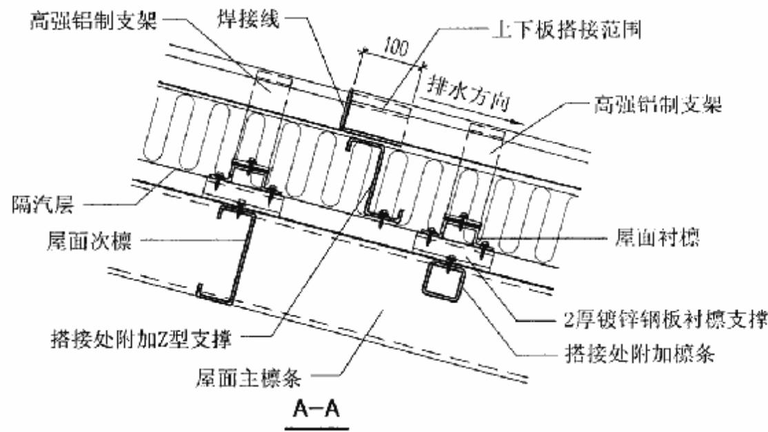
注：扇型板板宽窄端宜大于215mm，宽端宜小于460mm，板长宜在15~20m内选择，当大于此规格范围时宜采用搭接形式减小板材规格。
