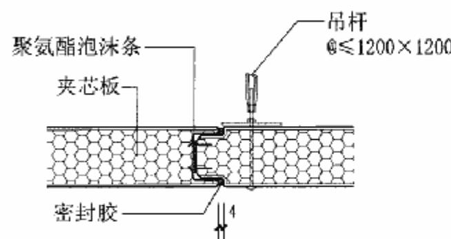
① 吊顶宽度方向连接
