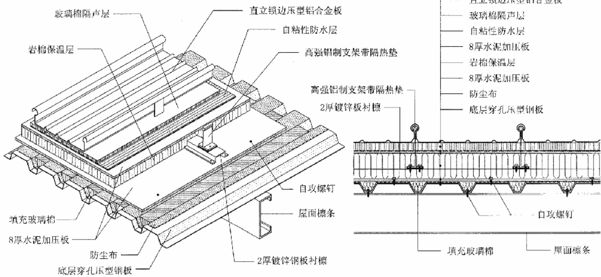
屋T4-压型铝合金板复合保温吸声屋面构造
