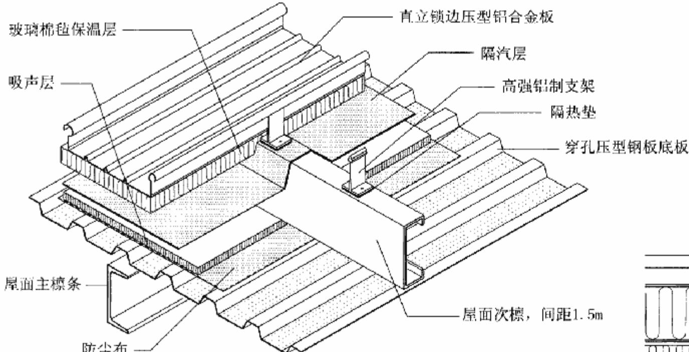
屋15A-压型铝合金板复合保温屋面构造
