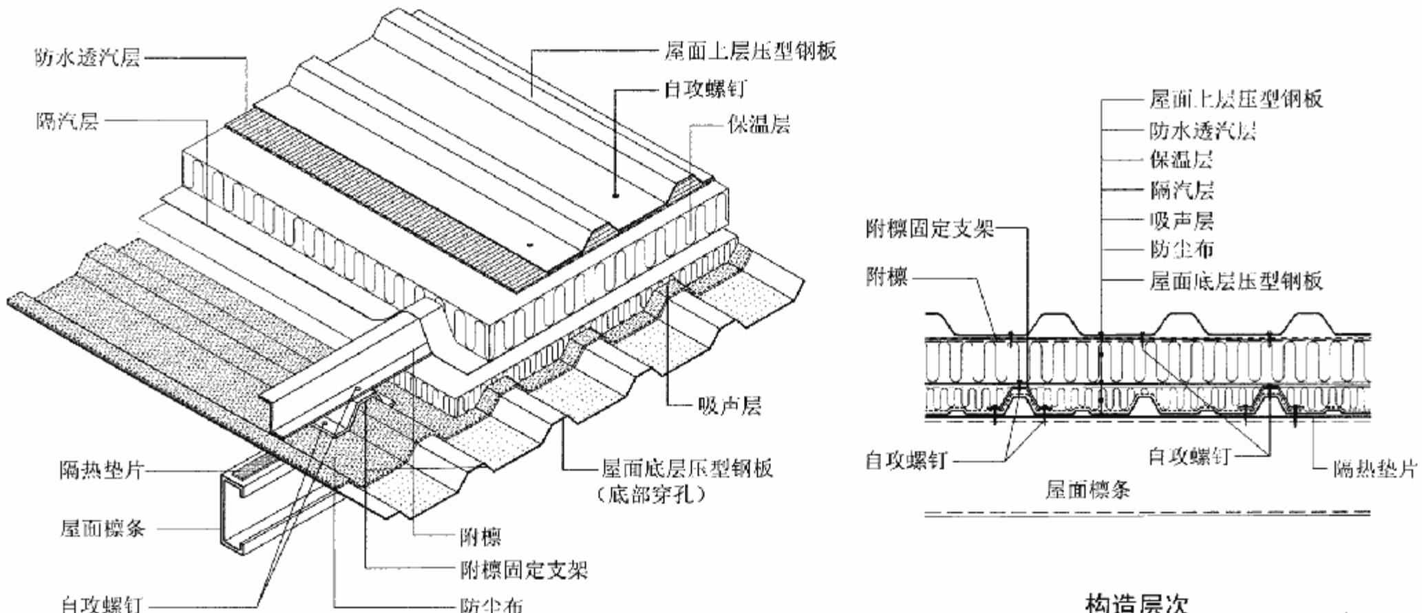
屋T3-压型钢板复合保温吸声屋面构造
