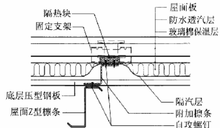
屋3A-双层压型钢板复合保温屋面(檩条露明型)说明、构造
