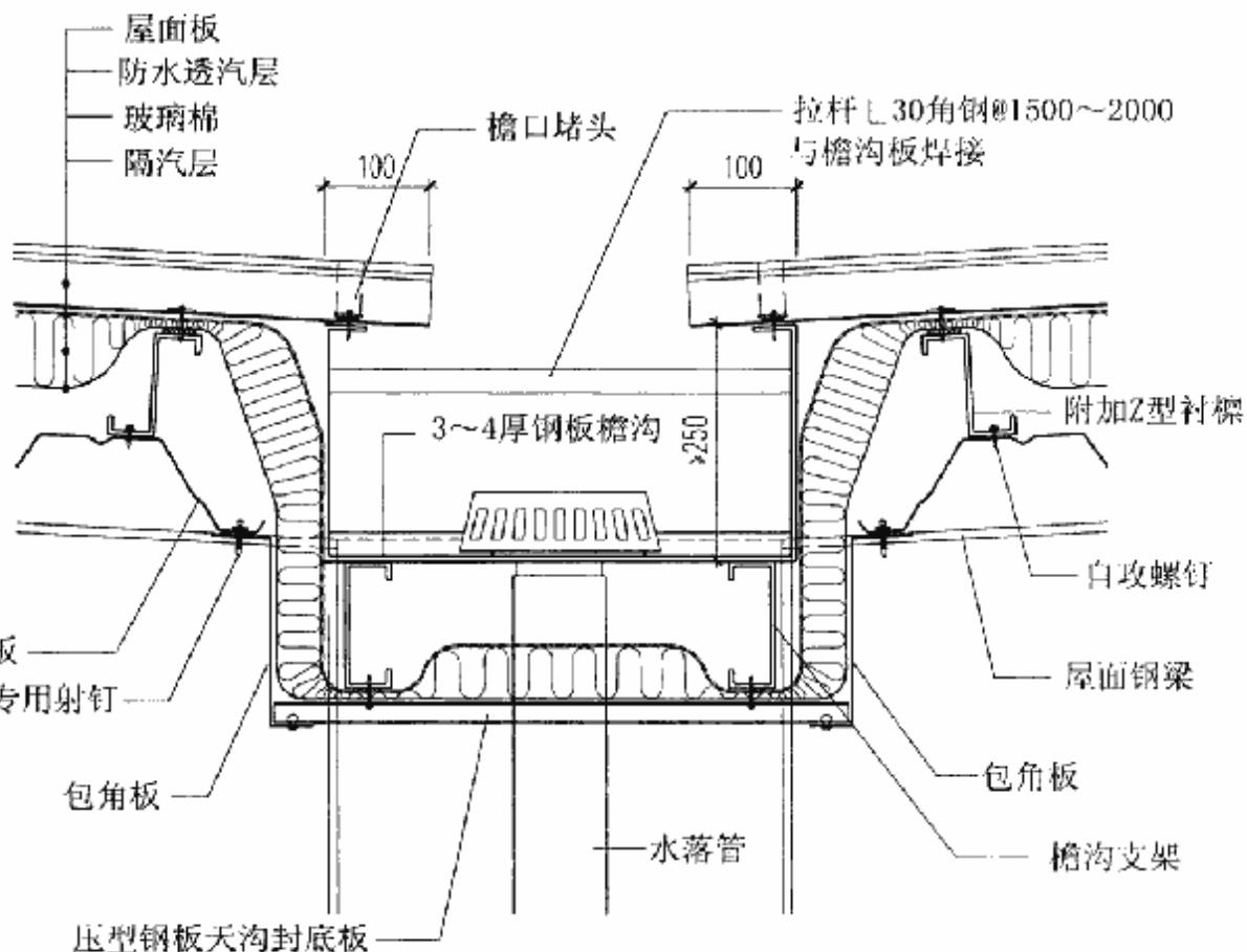
注：1. 檐沟断面、檐沟支架、水落管直径及间距按工程设计。
