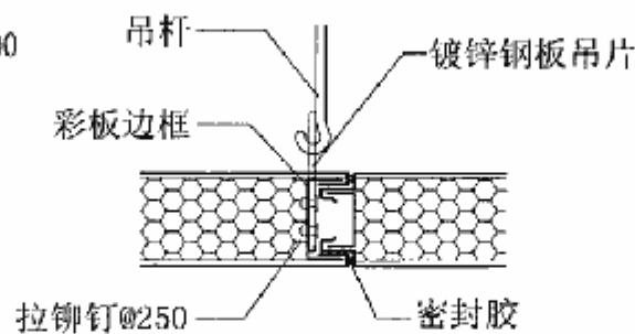
② 吊顶宽度方向连接
