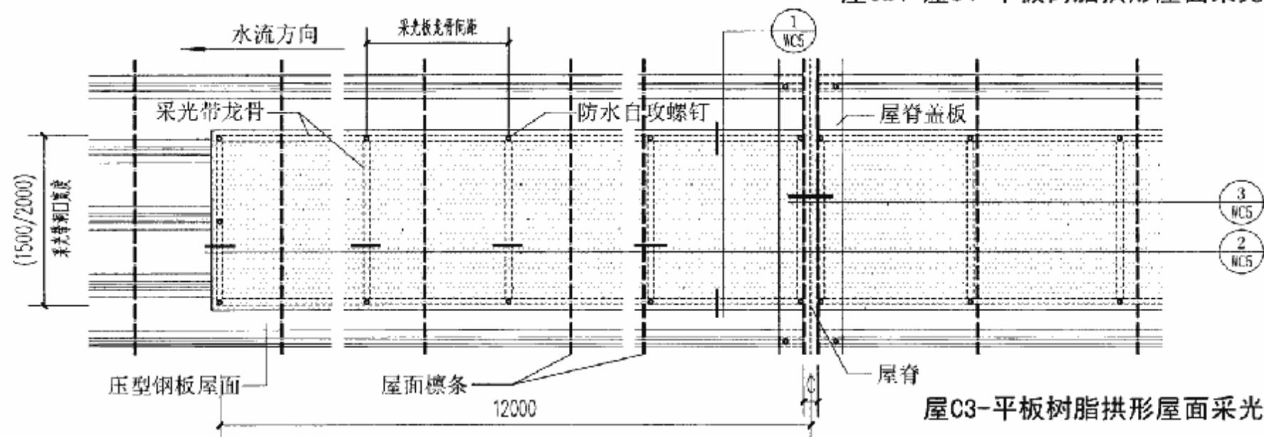
屋C3-平板树脂拱形屋面采光带构造
