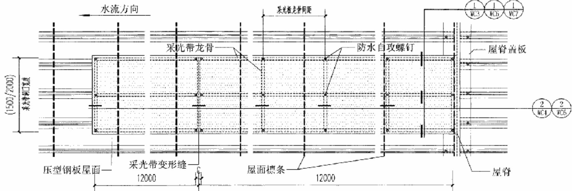
屋C2、屋C4-平板树脂拱形屋面采光带构造
