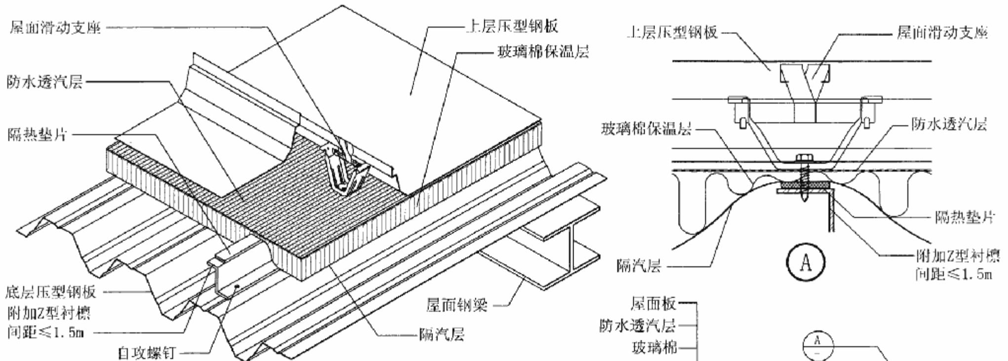
屋14-双层压型钢板复合保温屋面构造（无檩型）
