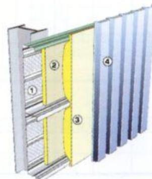
① 墙面承重内板 ②、③ 保温层 ④ 墙面外板
