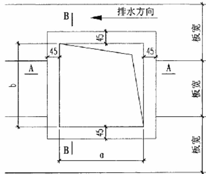
出屋面孔洞平面示意图
