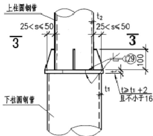
④ 不等直径圆钢管的工厂拼接(三)
