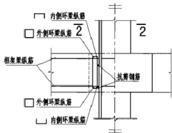
② 环梁—穿筋式梁柱连接
