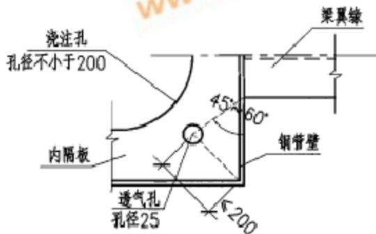
A 矩形钢管柱内隔板构造
