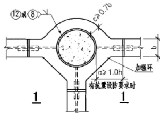
③ 直边形环板梁柱连接(边柱)
