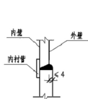
③ 不同壁厚钢管的工厂焊接构造(一)
