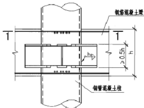
① 纵筋贯通—承重梁柱连接
