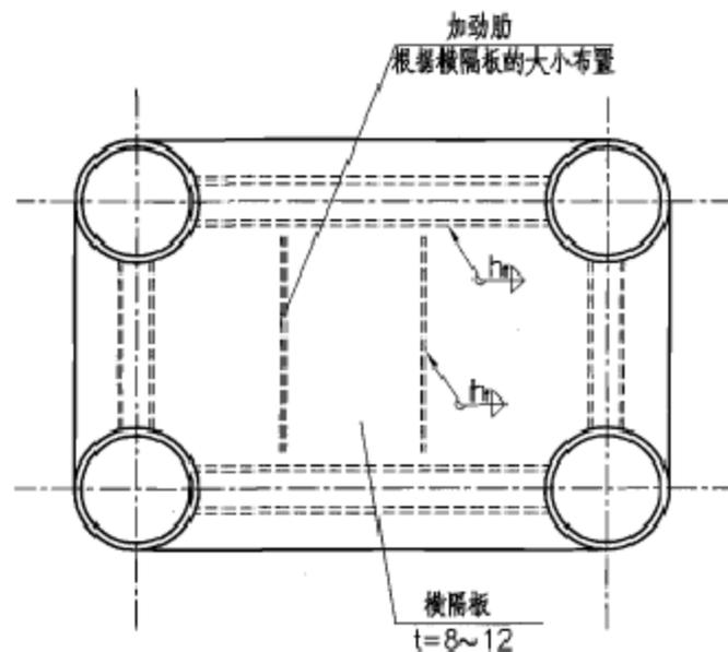
② 横隔板的连接构造
