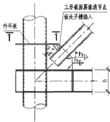
① 支撑斜杆与梁柱节点外环板铰接连接
