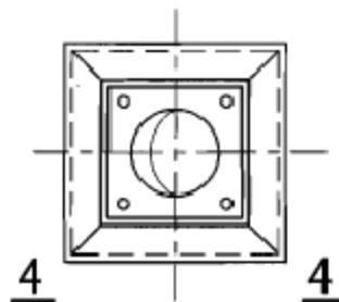
② 变截面矩形中柱的工厂拼接及当框架梁与柱刚性连接时柱中设置水平加劲肋的构造(二)
