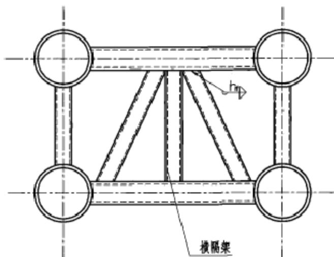
③ 横隔架的连接构造
