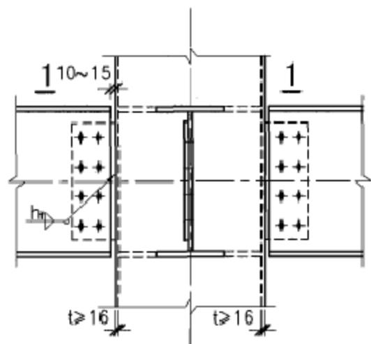
① 内隔板式梁柱铰接连接
