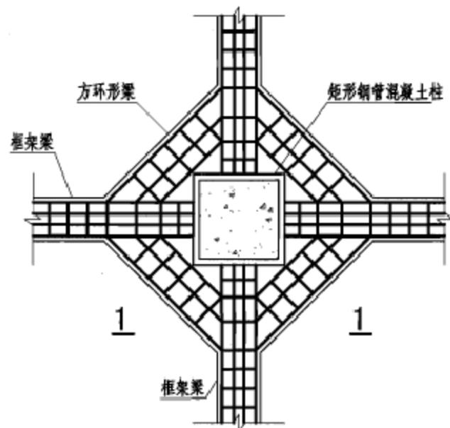
① 方形环梁—抗剪环式梁柱连接
