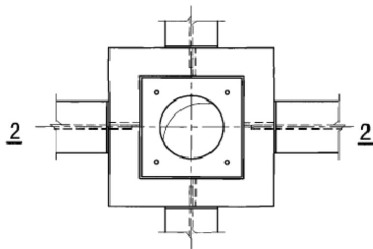
② 外伸内隔板式梁柱连接
