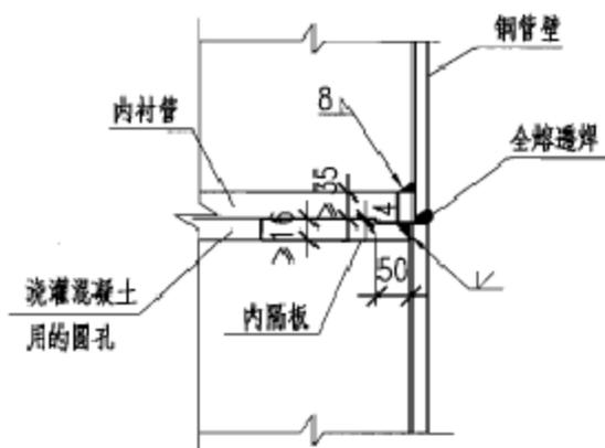
② 不同壁厚钢管的工地焊接构造
