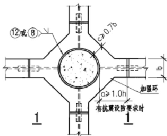
① 直边形环板梁柱连接(中柱)
