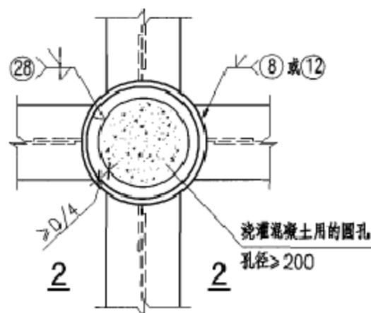
② 内隔板式的梁柱连接
