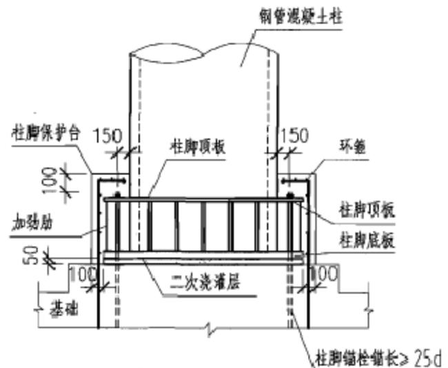
③ 外包式柱脚构造
