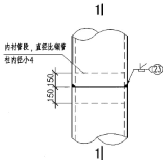
① 等直径圆钢管的工厂拼接
