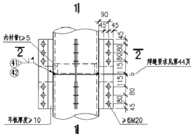
① 等直径圆钢管的工地拼接
