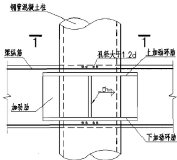
① 纵筋贯通式—环形牛腿梁柱连接
