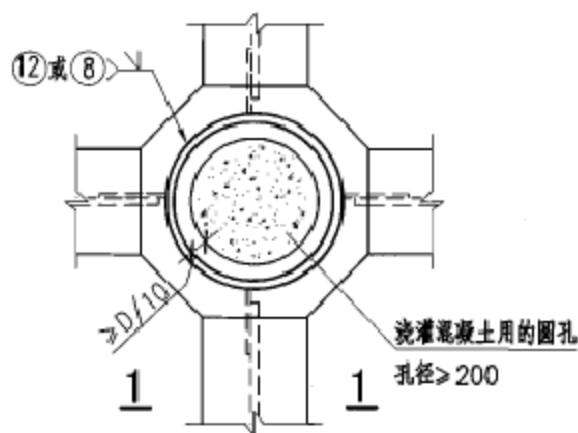
① 贯通式隔板的梁柱连接
