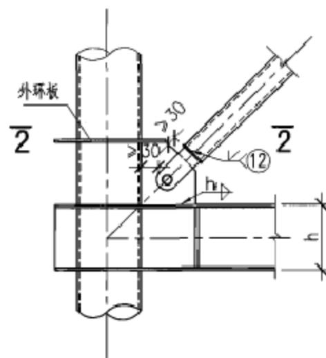
② 支撑斜杆与梁柱节点外环板铰接连接
