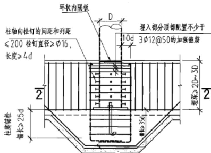
④ 埋入式柱脚构造
