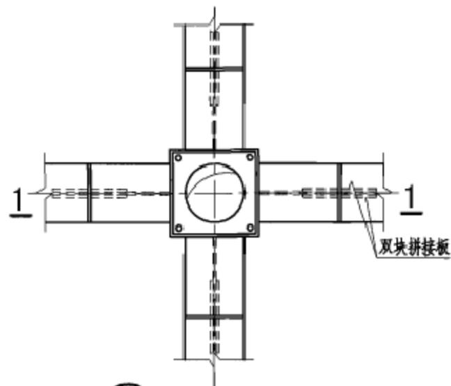
① 带短梁内隔板式梁柱连接
