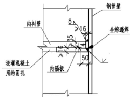
① 相同壁厚钢管的工地焊接构造
