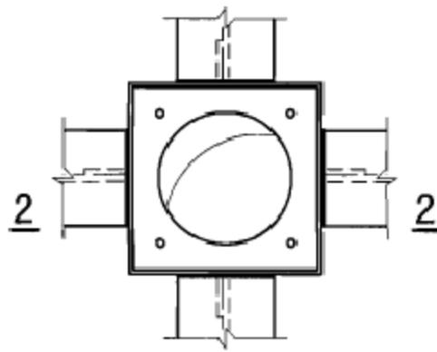
② 内隔板式梁柱连接
