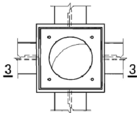
③ 贯通隔板式梁柱连接
