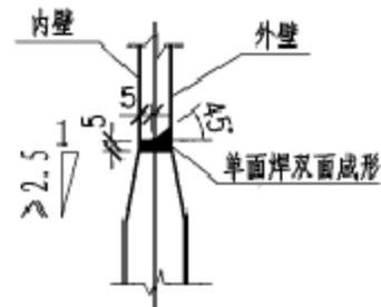
⑦ 不同壁厚钢管的工厂焊接构造(五)
