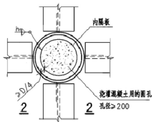
② 内隔板式的梁柱铰接连接
