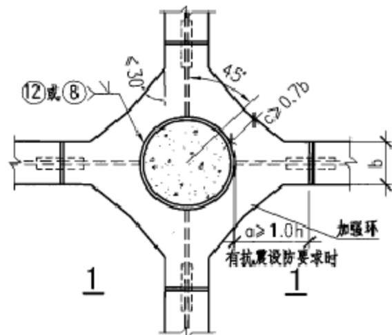
② 折线形环板梁柱连接(中柱)
