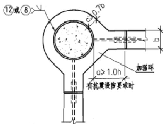
④ 同心圆环板梁柱连接(角柱)
