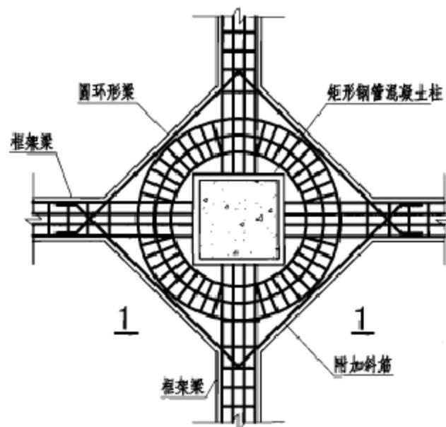
② 圆形环梁—抗剪环式梁柱连接
