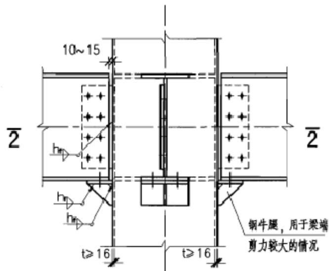
② 内隔板—牛腿式梁柱铰接连接
