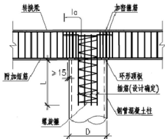
② 圆钢管混凝土柱的顶端节点
