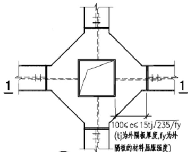
① 外隔板式梁柱连接
