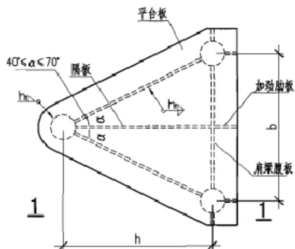
① 边列柱柱端构造
